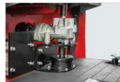
Elektronisches Servolenkungssystem (für Stand-Up-Traktoren)
