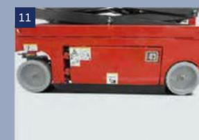
Umkippschutzsystem: Wenn die Maschine auf mehr als 2 m angehoben wird, arbeitet dieses System automatisch, um die Maschine vor dem Umkippen beim Gehen auf unebenem Boden zu schützen
