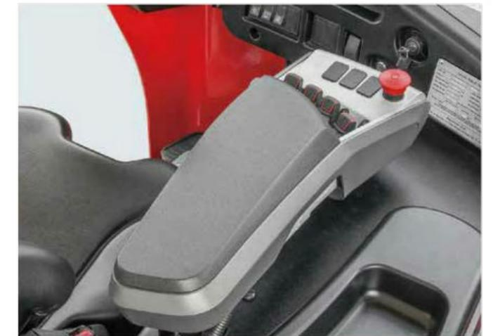
Fingerspitzenystem integriertes Steuerungssystem, mit gut Mensch-Maschine-Funktion
