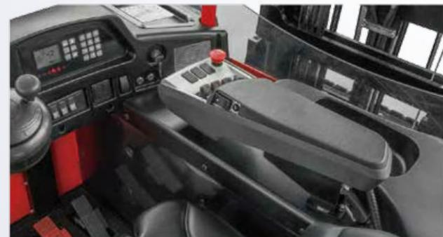
Das elektrische Lenkrad ist klein und leicht. Der Bediener kann es einstellen, indem er sich vorwärts oder rückwärts bewegt, um eine geeignete Position zu finden. Das Lenkrad verfügt über einen eingebauten Dämpfer mit zuverlässiger Signalübertragung des Schrittmotors.
