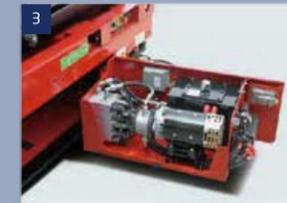
Hydraulisches und elektrisches System
