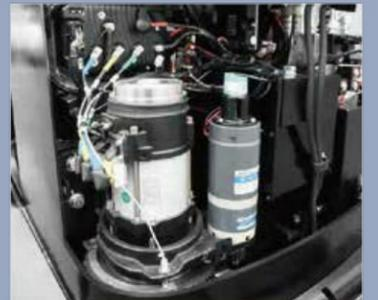
EPS (Electric Power Steering) ist Standardspezifikation
