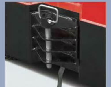
Aufgrund der speziellen Konstruktion kann die Zugvorrichtung verhindern, dass sich der Zugstift während der Fahrt löst
