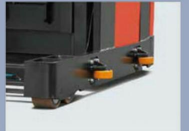
Schienenführungsrollen (opt.) Können für VNA-Arbeiten am Stapler montiert werden
