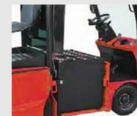
Seitenwechsel Batterie Design ist praktisch zum Batteriewechsel
