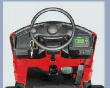
Modernes Gliederungsdesign mit LCD-Instrument und USB-Ladeanschluss
