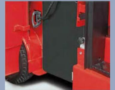
Die Batterie kann aus dem Stapler entfernt werden, so ist es sehr praktisch für die Batterie Instandhaltung
