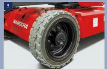
Reifen: schaumgefüllte Reifen mit guter Geländeleistung
